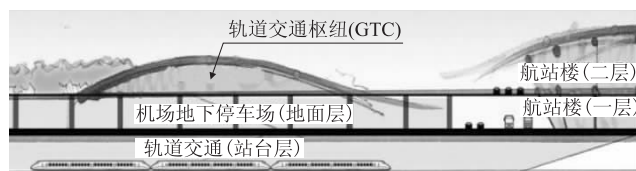
图 14 新机场站采用地下敷设方式示意图
