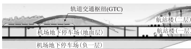
图 13 新机场站采用高架敷设方式示意图
