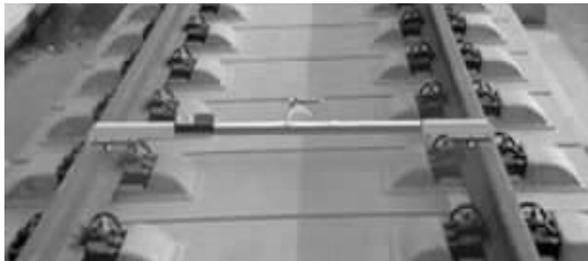
图 7 电子道尺检测
