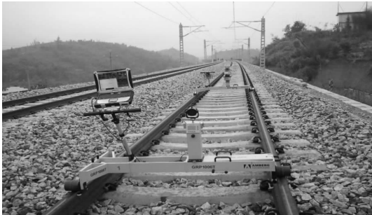
图 4 安博格测量小车线路精测
