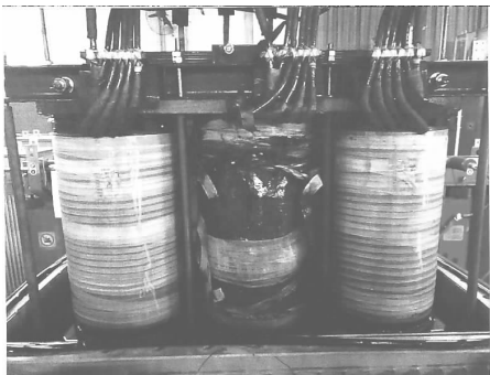
图 3 变压器吊芯检查图
