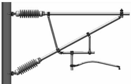
图 1 简化腕臂结构和定位装置正定位示意图
