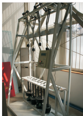
图4 吊弦疲劳试验台图
