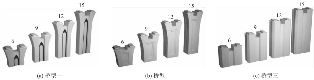
图 6 三种墩型不同墩高透视图
