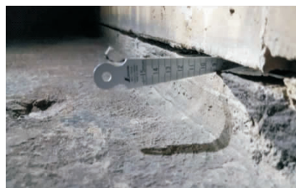
图 1 用塞尺测量轨道板与砂浆层之间离缝值
