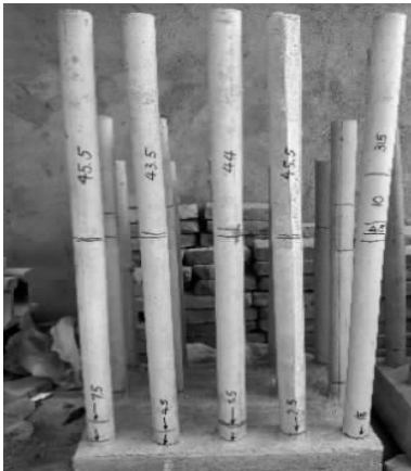
图8 桩体破坏实物图
