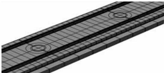
图 1 CRTS I 型板式无砟轨道结构图
