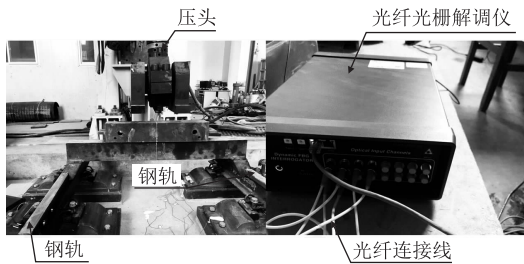
图3 实验装置图
