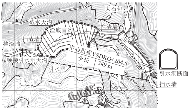
图7 引水洞+两侧天沟排水系统平面示意图
