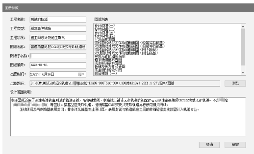
图 8 轨道二维图纸生成参数设置图
