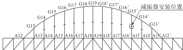
图 5 阻尼器安装位置图
