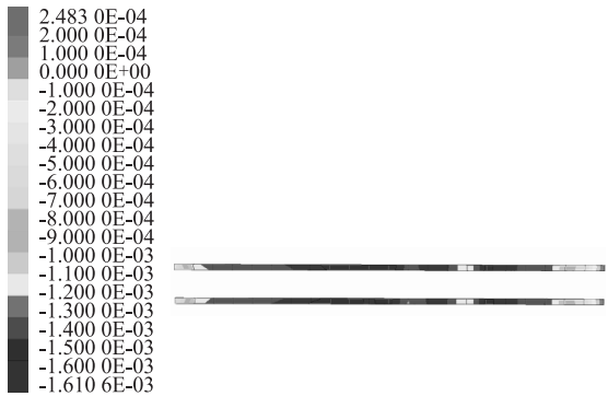
图 10 高速铁路线路沉降云图(m)
