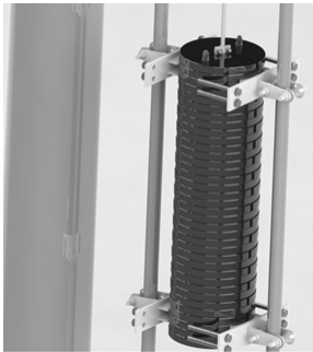
图 2 接触网防风型坠砣限制架示意图
